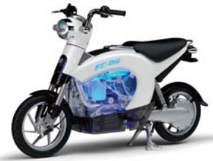
DMFCで動く電気バイク FC-Dii(2)
